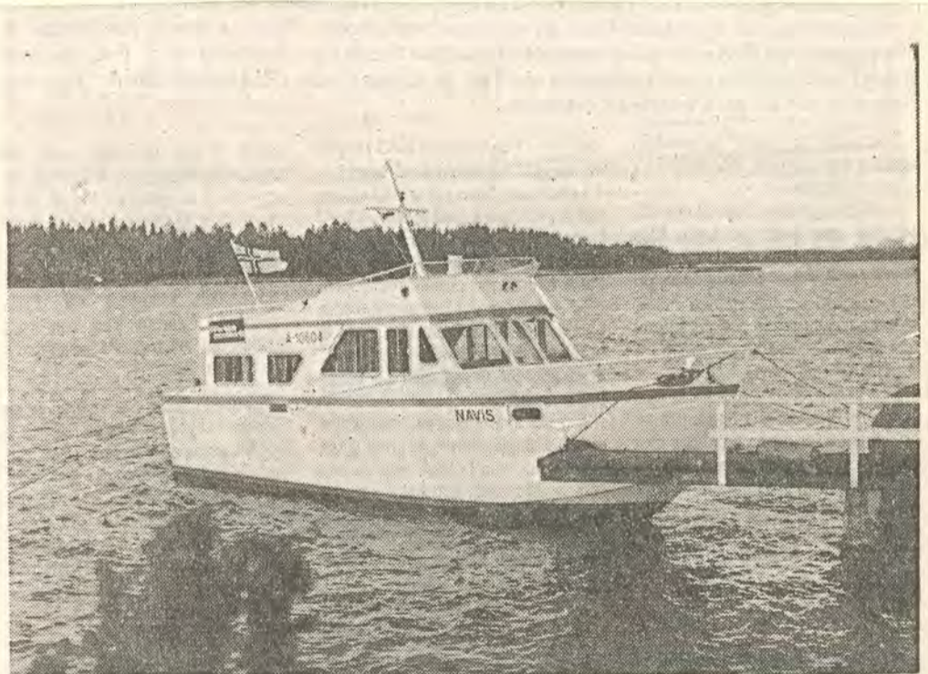
Navigationssällskapet har i "Navis" en bra utbildningsbåt. Den är 13 meter lång med två däck och försedd med ett riktigt klassrum.
